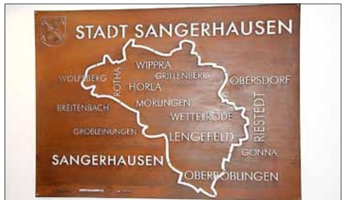
Übrigens: Die Platte ist aus sogenanntem Corten-Stahl. Dieses Material hat eine sehr eigene, charakteristische Patina in erdigen und warmen Farbtönen. Corten-Stahl hat eine überdurchschnittlich lange Lebensdauer, braucht nicht lackiert zu werden und ist vollständig recyclebar. Sie hat eine Stärke von 5 mm und ist 1,5 x 2 Meter groß.
